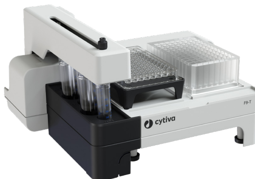
图 9. 双板组分收集器 F9-T 支持多种型号的深孔板 (24、48 和 96 孔), 96 孔微孔板或者试管 (0.5、1.5、2 mL 和 50 mL) 中收集
