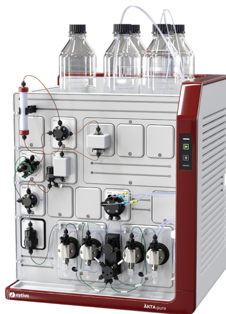
图 1. ÄKTA pure 是一个灵活的分层系统，可在实验室规模上可靠地纯化蛋白质、多肽和核酸。
